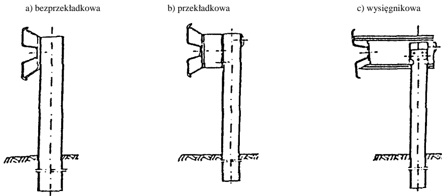
Załącznik 11.3. Zasady określania wysokości prowadnicy bariery nad poziomem terenu, wg [32]
